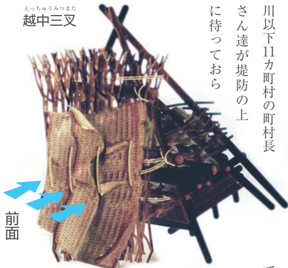
丸太を三叉に組み、その中に玉石を詰めた簡易の堰。堰前面には粗朶を並べ、上に簀をかけて漏水を防止した。
