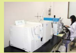
ガスクロマトグラフ質量分析計(GC-MS) ●揮発性有機化合物 ●トリクロロエチレン ●テトラクロロエチレン ●四塩化炭素 ●ジクロロメタン など
