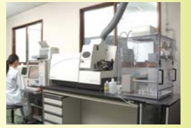
高周波誘導結合プラズマ発光分光・質量分析装置(ICP/MS) ●重金属(Cd、Pb、Znなど)
