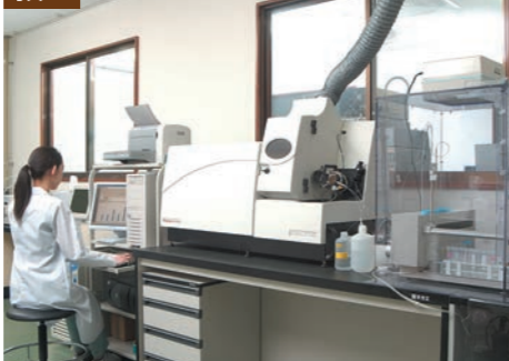
高周波誘導結合プラズマ発光分光・質量分析装置(ICP/MS)
