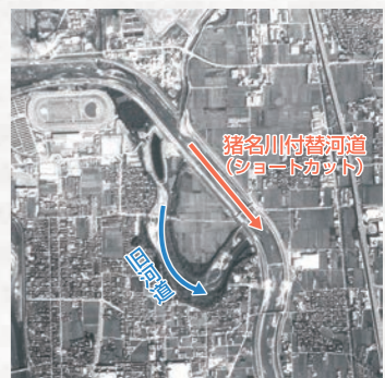
猪名川付替河道（利倉捷水路）の建設 （写真提供：猪名川河川事務所 昭和45年頃撮影）
