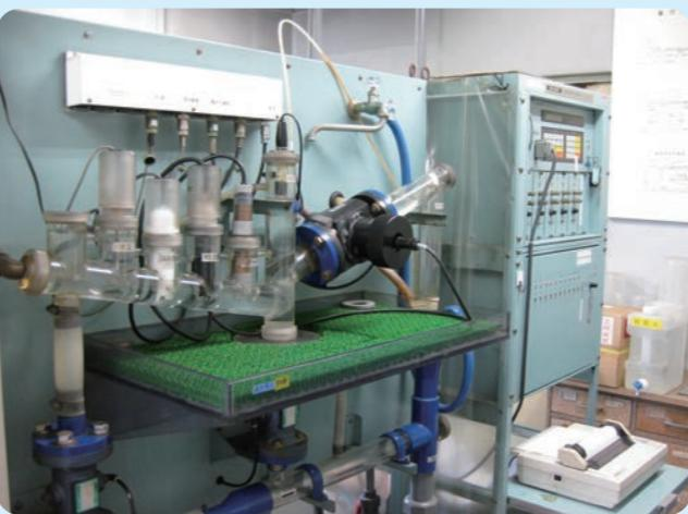
K82型 S型水質自動監視装置（アナテック・ヤナコ社製）
