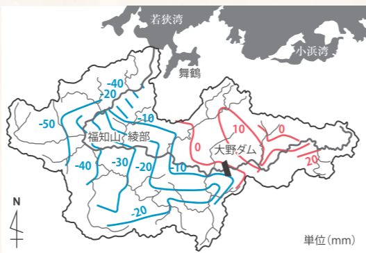
図-7 平成25年と平成16年の洪水到達時間内雨量の差(平成25年値-平成16年値)
