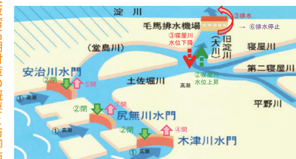
図2 淀川大堰、毛馬排水機場、大阪府三大水門の操作
