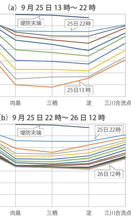
図-1(a),(b) 宇治～三川合流点迄の水面形の時間変化
