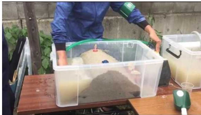
図 10 実験模型 (左) 巨椋池流域模型ビオトープ，(右) 堤防決壊実験模型
