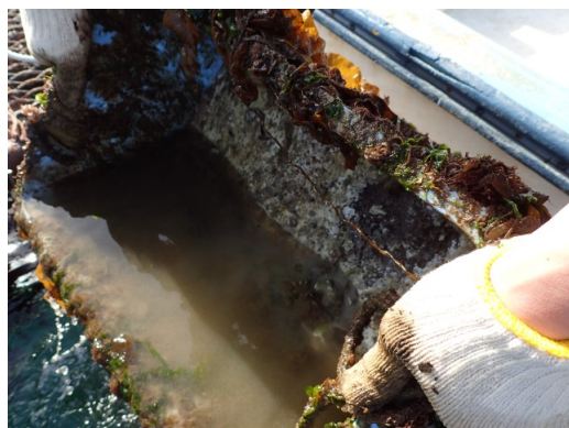
図-18 水硬化した鉄鋼スラグ (2021年3月)
