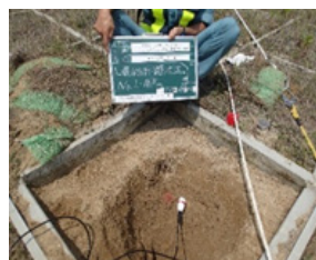
写真-1 土壤水分センサ設置状況
