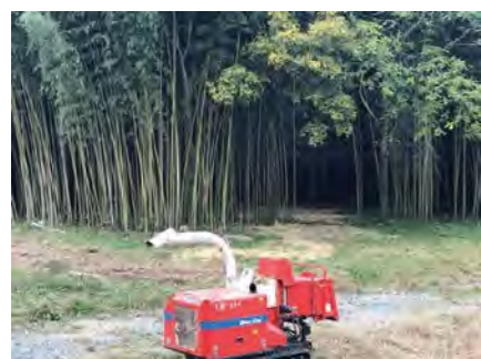
竹チッパーを使って竹チップを遊歩道の舗装に使用
