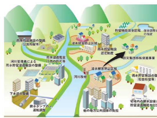
特定都市河川流域におけるハード・ソフト対策のイメージ 【資料提供：国土交通省 近畿地方整備局】
