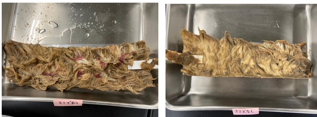
図4 パイル担体 (試験系) , 右) パイル担体 (対照系) .
