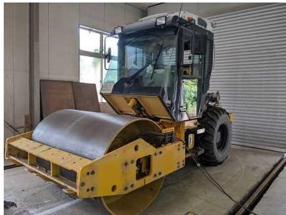
図-4 検証に用いた 7t 級振動ローラ
