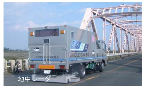
写真-3 電磁波レーダを搭載した計測車両
