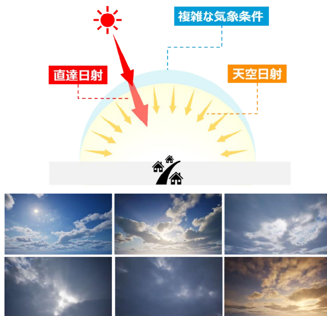
図-2 天空光の模式図(上段)とゲームエンジンによる様々な雲量・時間帯の天空照光環境設定(下段)
