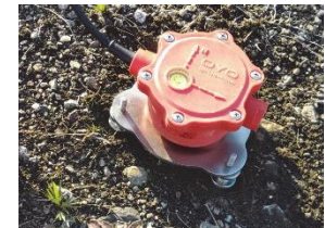
レバリングプレートでの設置
