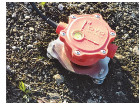
レバリングプレートでの設置
